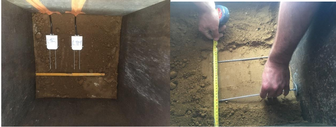
Figure 1 : Exemple d'installation de sonde TDR (photo de droite) et de réservation (photo de gauche) dans un ouvrage en pisé.
